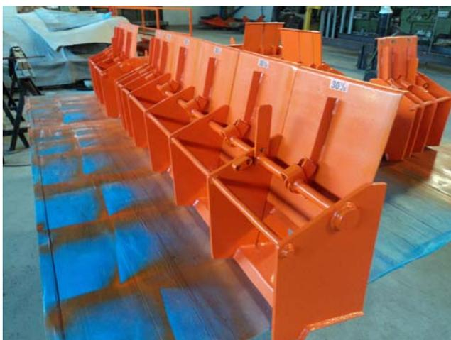
La regulación del caudal se efectúa con la apertura o el cierre completo de compuertas, cada una de las cuales determina un caudal predefinido.
